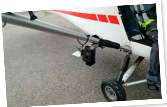
Appareil numérique fixé sur un hauban de l'ULM permettant de réaliser les ortho-photographies pour faire des cartes
